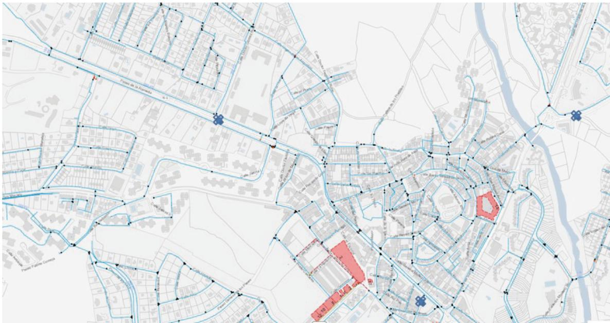
**Figura 15.** Vista general de la distribución en el municipio de Guadarrama. El emisario (titularidad de Canal de Isabel II) que recoge las aguas residuales de Guadarrama y las conduce a la EDAR el Chaparral (Estación Depuradora de Aguas Residuales), donde se realiza la depuración de las aguas residuales de Guadarrama para su vertido al río Guadarrama. Tomado del sistema de cartografía del Canal de Isabel II. App: Vicario.
