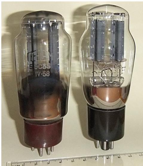
Figura 3, Válvula de vacío. Fuente: <https://commons.wikimedia.org/wiki/File:5C3Ss.jpg>
