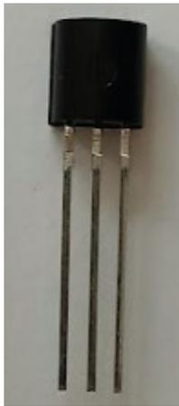
Figura 2, Transistor, Elaboración propia
